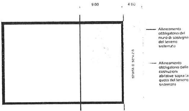
Possibilità di interruzione del muro di sostegno obbligatorio a confine con la strada di servizio (esemplificazione)
